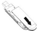
3. Insira o chip com a área de contato de metal virada para baixo e empurre o chip na abertura até o final, como mostra a figura abaixo.
